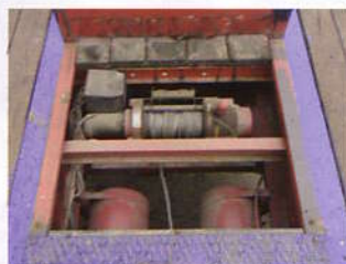
Der Tieflader verfügt, versteckt unter einer Abdeckung, über eine Seilwinde mit fünf Tonnen Zugkraft.
