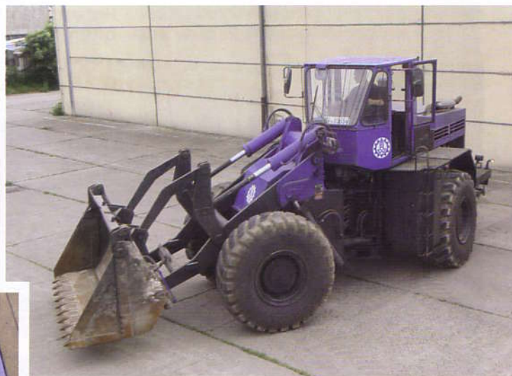
Meistens ist der Radlader ohne Blaulicht unterwegs, da beim Transport mit dem Tieflader die Höhe von vier Metern überschritten würde. An der Schaufel ist die seitliche Verzahnung gut erkennbar.
